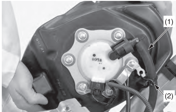
(1) manguera de suministro de combustible (2) abrazadera
